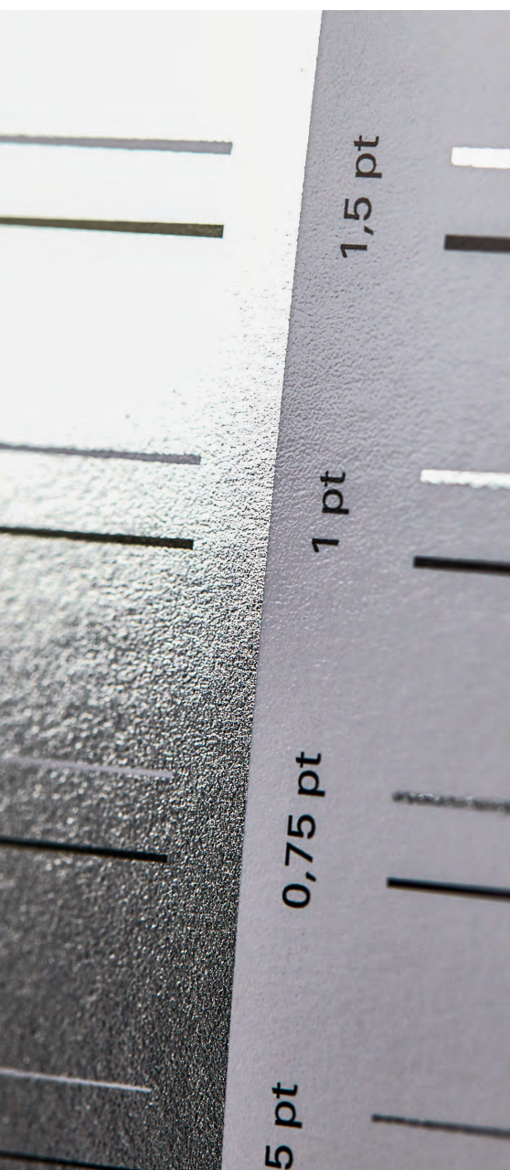
Kaltfolientransfer und passgenaue Überdruckung in einem Arbeitsgang (Bild: GRÄFE Druckveredelung GmbH aus Bielefeld)
